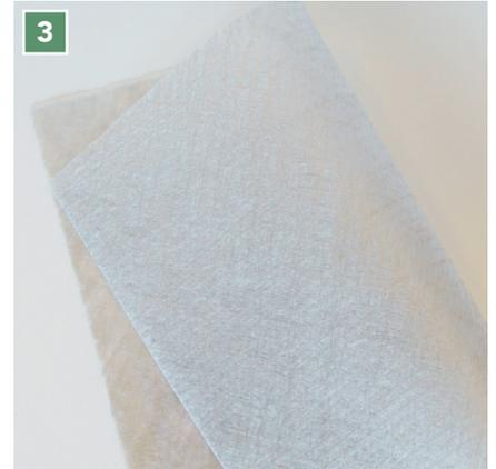
Dient zur Trennung der verschiedenen Schichten und verhindert das Einschlämmen von Feinteilen des Substrats in unterhalb liegende Ebenen.
